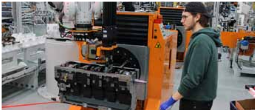
Monteur Julius Salmela installeert een krukas met behulp van een industriële robot.
