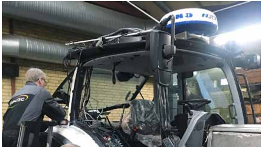
De Valtra N154 is een multifunctionele machine die is uitgerust met een breed scala aan hulpmiddelen, waaronder een maritieme radar, een infrarood warmtecamera en een zoeklicht.
