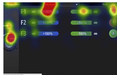
Speciale camera's volgden de oogbewegingen van de SmartTouch testers. Ontwikkelaars konden daardoor vaststellen of gebruikers de functies vonden waarnaar ze op zoek waren en de pictogrammen begrepen.
