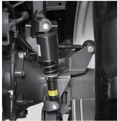
De mechanische cabinevering is instelbaar en is voorzien van dubbele stabilisatiestangen.
