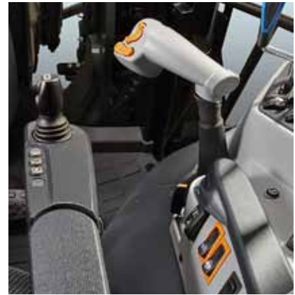
De transmissie is eenvoudig te bedienen dankzij de ergonomische hendel en tuimelschakelaars.
