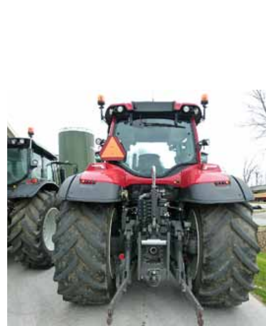
De tractor staat op een set bredere banden om de grasmat te sparen.
