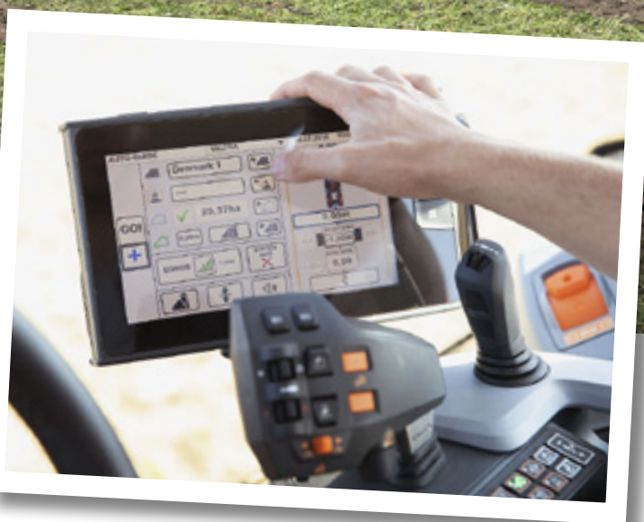
De Auto-Guide maakt het mogelijk om tractoren en oogstmachines precies op elkaar af te stemmen.
