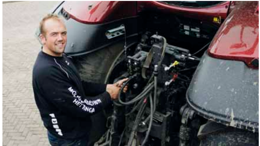
De vier hydrauliekaansluitingen zijn allemaal links geplaatst. „Makkelijk tijdens het aansluiten”, vindt Willem Jelgerhuis. In de Active wordt de oliestroom gewoon met hendels bediend.
