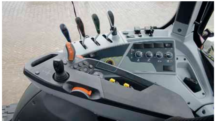
Het pookje voor de powershift, de groepen en de automatische stand bevindt zich op de rechter armleuning. Evenals de bediening van het handgas, de cruise-control, de hef en de aftakas.
