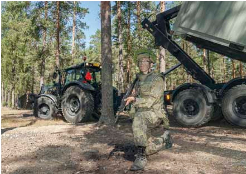
De tractoren hebben hun veelzijdigheid al bewezen bij het Finse leger. Ze kunnen voorraden in het bos laden en lossen, containers met een gewicht tot 16 ton voorttrekken en deze handlen met haakarmtrailers. Bovendien kunnen tractoren worden gebruikt om – ook voor andere voertuigen – wegen om te ploegen.
