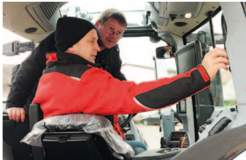
Het C3000 display is alvast geïnstalleerd voor het AutoGuide GPS systeem.
