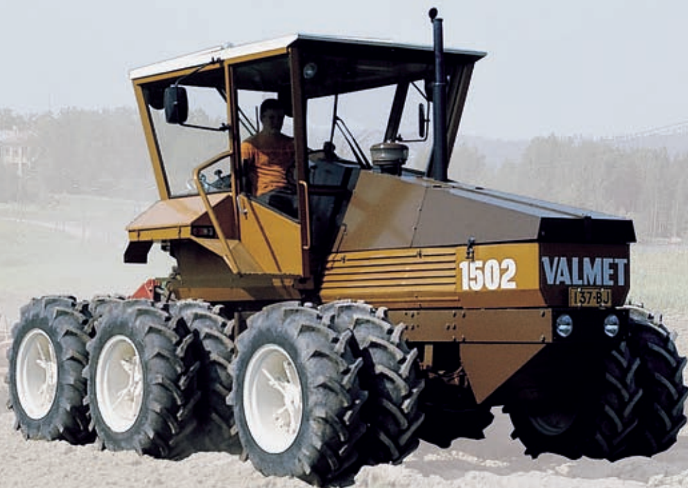
De Valmet 1502 zag er indrukwekkend uit. De tractor trok en stuurde veel beter door zijn aangedreven vooras. Aangezien er geen geschikte tractorbanden verkrijgbaar waren, stond hij op dubbele wielen maat 13,6-24.
