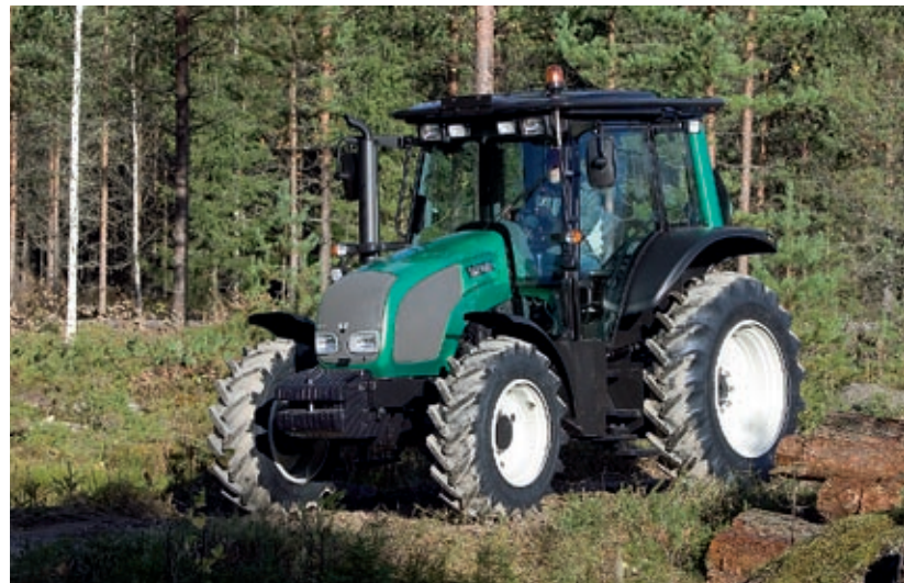
De N-serie is ook leverbaar met een bosbouwcabine, een gaspedaal achter en een beschermde brandstoftank, zodat hij ideaal is voor werk in het bos.
