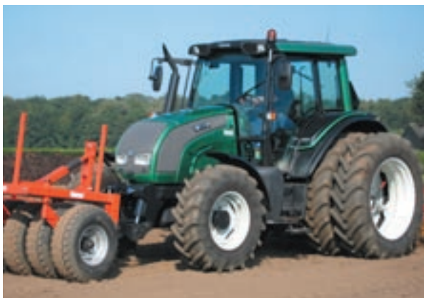
De Valtra N101 kan de grond over de gehele breedte (drie meter) gelijk aandrukken.
