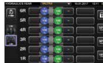
U kunt iedere knop aanwijzen om elke hydraulische functie te bedienen, inclusief front- en achterventielen, front en achterhef en de voorlader.
