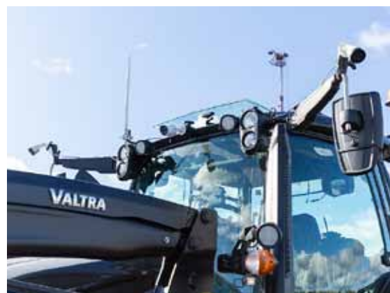
Aan de buitenkant gemonteerde camera's laten de bestuurder zien wat er rondom de tractor gebeurt.
