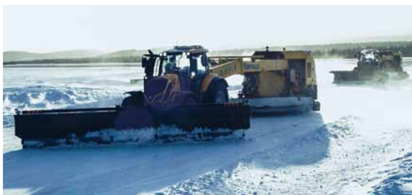
De tractorbedieningen hier bevinden zich in een busje. Het is ook mogelijk om een tractor op afstand te besturen met behulp van de besturing in een andere tractor of bij meer beperkingen, met behulp van een draagbare besturingseenheid.
