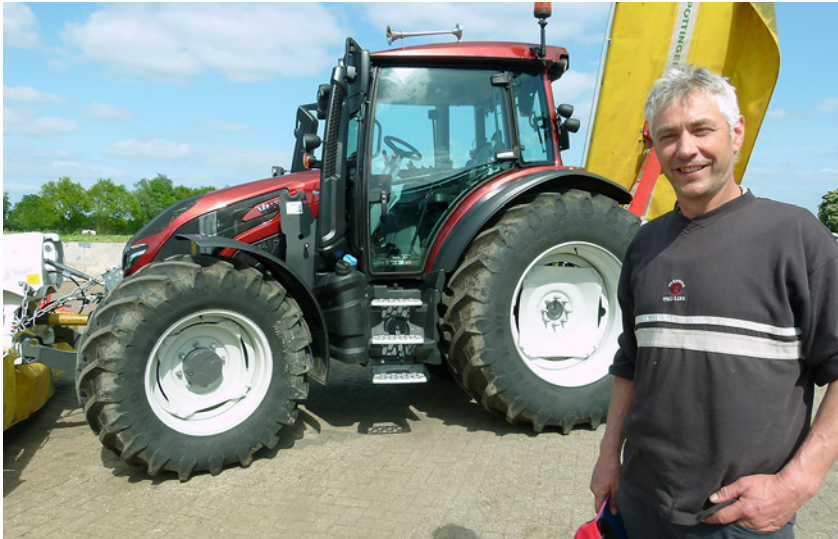
Ik kan schakelen zonder te koppelen. De trekker heeft veel versnellingen. Er zit zelfs een kruipbak op.
