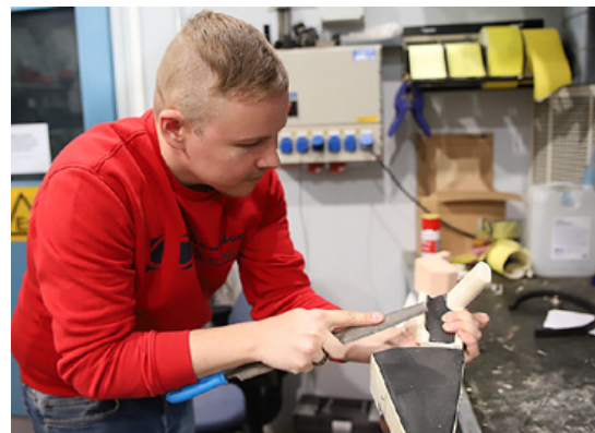
In de ontwerpstudio worden veel plastic, hout en 3D-geprinte componenten gebruikt om mock-upmodellen op ware grootte te maken van toekomstige tractoren en cabines.
