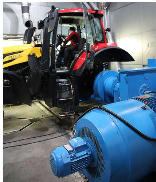
Jan-Erik Karjula bestuurt een tractor op de proefbank. De resultaten worden gebruikt om zowel de trekker als de simulator verder te ontwikkelen.
